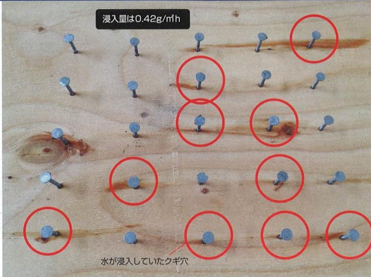
実験開始から24時間後にアスファルトルーフィングを剥がした状態。赤丸を付けた10カ所で、青インクで着色した水の浸入痕が見つかった
